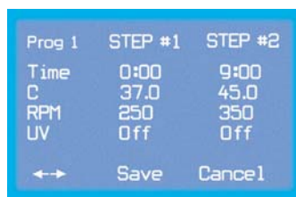
可程式化控制器能以時間為基礎自動化改變參數
